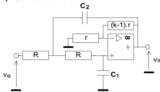
$$\text{Si } k = 1 \text{ (suiveur)} \quad \omega_0 = \frac{1}{R\sqrt{C_1 \cdot C_2}} \quad R \text{ arbitraire}$$
