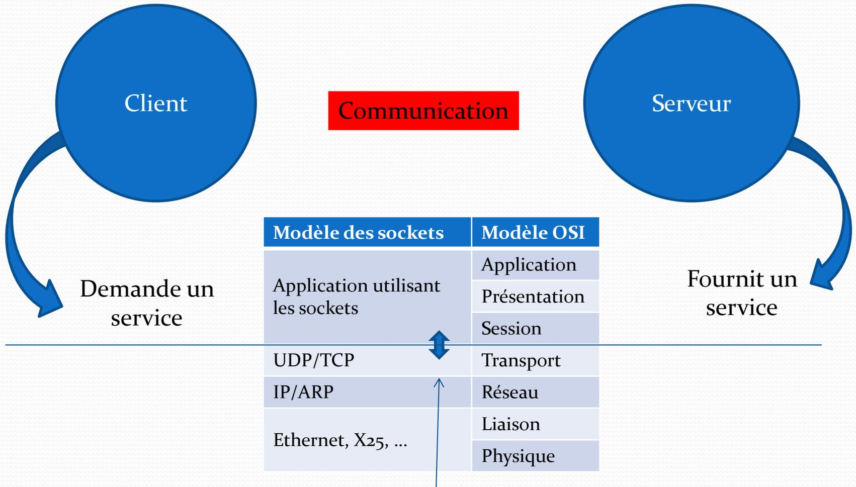
Il apparaît au niveau du client et du serveur le besoin d'un connecteur, qui relie la couche application à la couche transport. On parle de socket.
