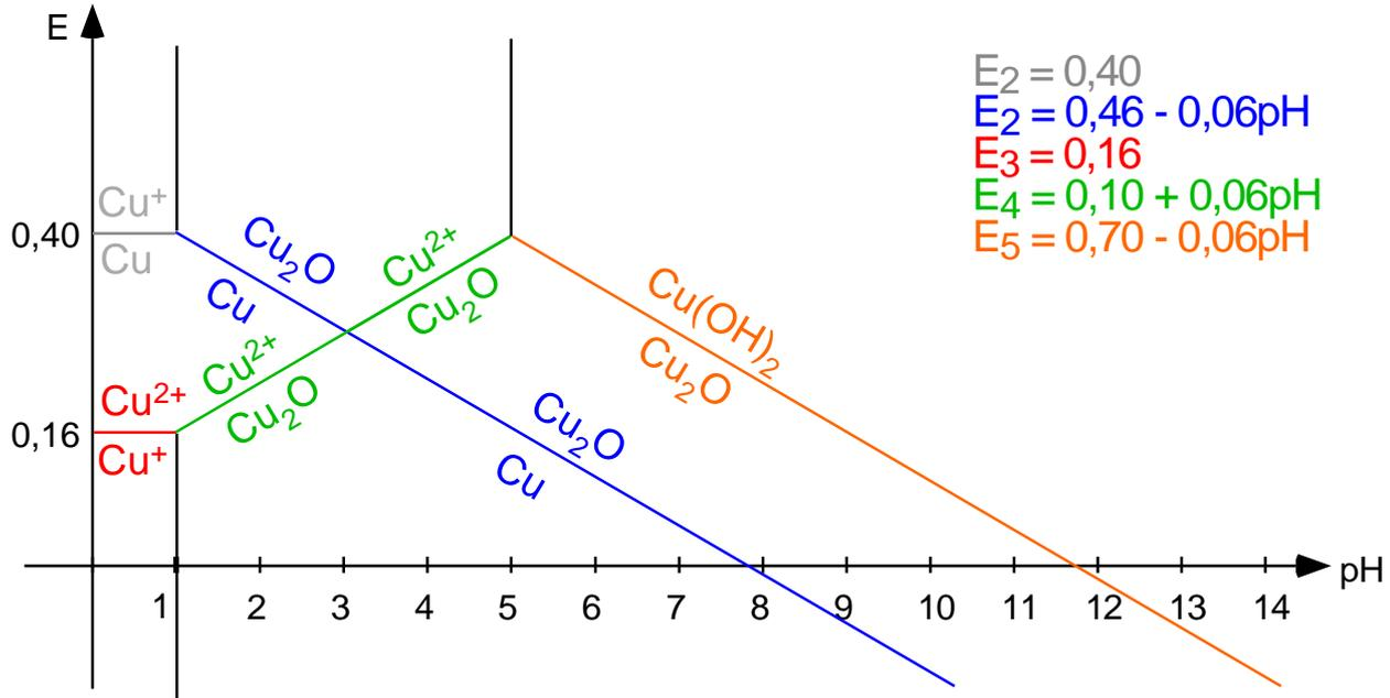
7°) Etude du couple  $\text{Cu}^{2+}/\text{Cu}$  pour  $\text{pH} \leq 3$  :
