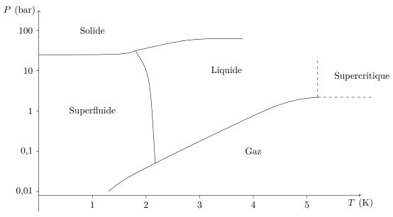
Figure 7 Allure du diagramme des phases de l'hélium : pression en fonction de la température
