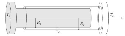
Figure 6 Schéma d'un interrupteur thermique à gaz
