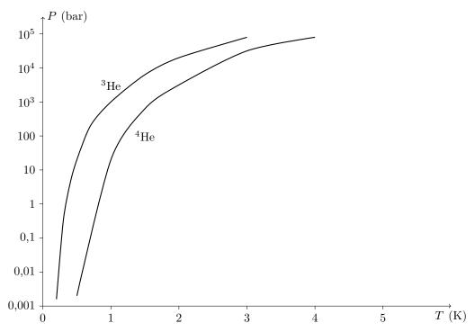
Figure 8 Pression de vapeur saturante de <sup>3</sup>He et <sup>4</sup>He en fonction de la température
