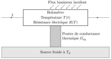
Figure 1 Schéma d'un bolomètre
