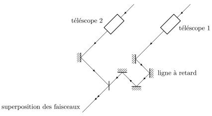
Figure 3 Principe du VLTI
