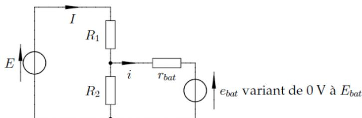
Figure 3 – Circuit utilisé pour charger la batterie
