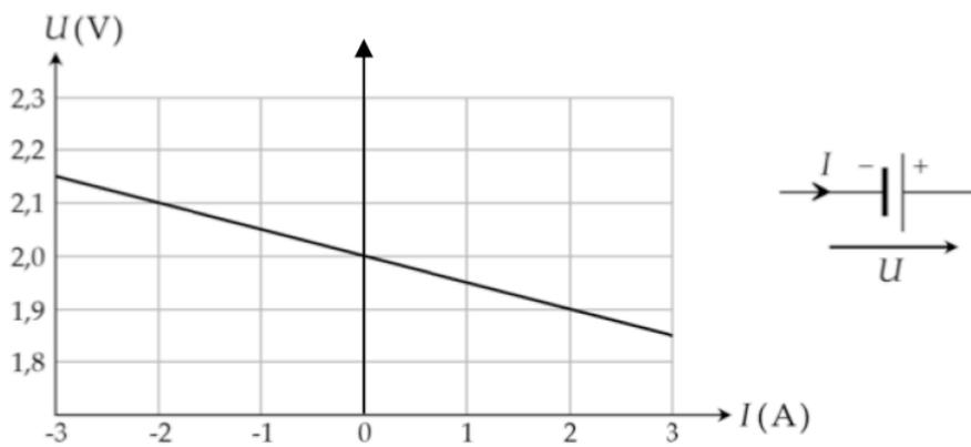
Figure 2 – Caractéristique statique d'un accumulateur chargé à 50 %
