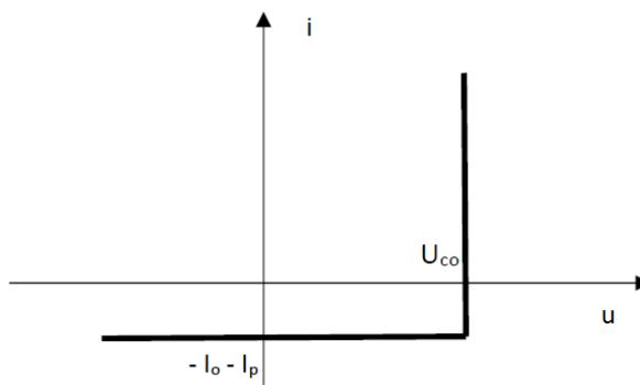
On modélise la photodiode selon la caractéristique idéalisée précédente. Cette photodiode est connectée en série avec une résistance de charge  $R_c$ . Déterminer graphiquement le point de fonctionnement du circuit. On prêter attention à l'algébrisation de la relation courant-tension sur le résistor de résistance  $R_c$  et donc de conductance  $1/R_c$ .
