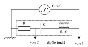
(boîte à décade). L'image du courant sera obtenue en prélevant la tension aux bornes du résistor (voie 2), la tension délivrée par le générateur étant toujours prélevée par la voie 1. Réaliser le montage représenté ci-contre.
