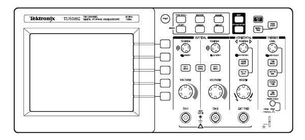
À gauche se trouve l'écran, en bas duquel la ligne d'état résume la configuration de l'oscilloscope. À droite se trouve l'ensemble des boutons permettant un affichage correct du ou des signaux d'entrée.
