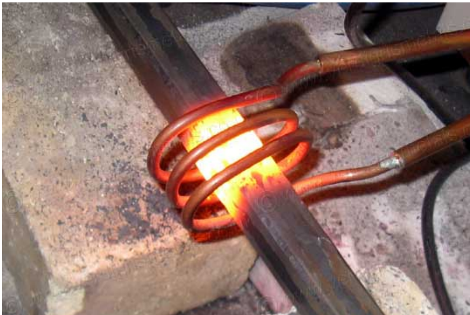
FIGURE 1 – Métal chauffé par induction électromagnétique Crédits : David Hyde
