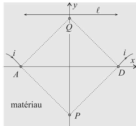
FIG. 3 – Géométrie de van der Pauw : les points  $A$ ,  $P$ ,  $D$  et  $Q$  forment dans cet ordre un carré.
