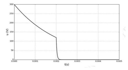
14. Comme expliqué plus haut, lorsque k est fermé le condensateur se décharge dans r et la tension u passe très rapidement sous le seuil  $U_0$  permettant au tube de s'éteindre. Ainsi  $\Delta t$  est bien la durée du flash. L'énergie libérée est donnée par
