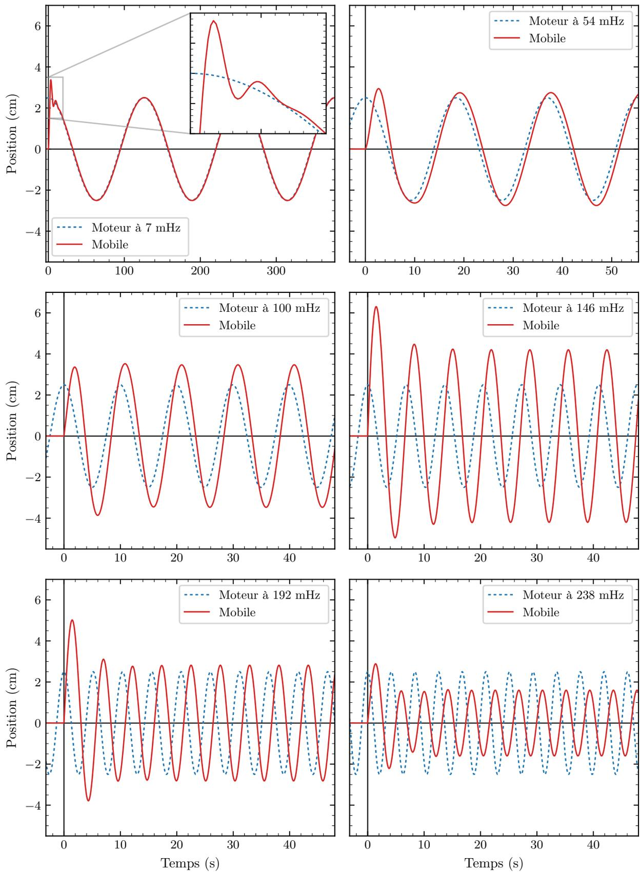
**Figure 1** – Mesures de la position du mobile en fonction du temps et de la position imposée par le moteur à différentes fréquences.
