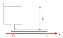
On admet que le débit dans le tube horizontal est donné par la loi de Poiseuille :  $q_v = \frac{\Delta P}{128 n L} \pi d^4$
