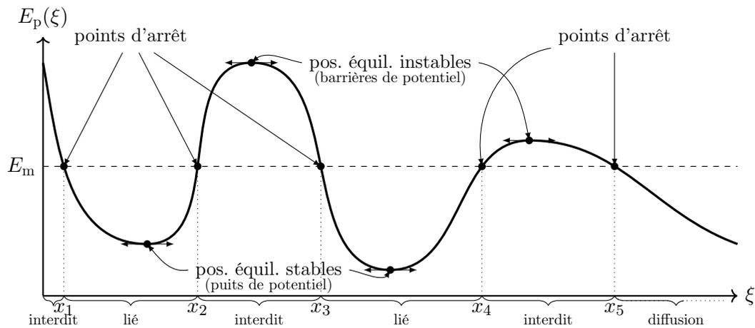
**Figure 1** – Un profil d'énergie potentielle, les points d'arrêts et zones interdites compte-tenu de la valeur de l'énergie mécanique.
