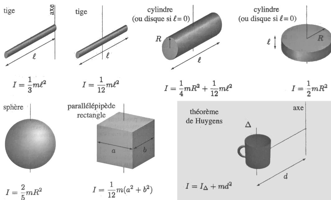
**Figure 1** – Valeurs des moments d’inertie  $I$  par rapport à un axe de quelques solides homogènes [1]. Dans les expressions,  $m$  désigne la masse totale du solide. L’encadré rappelle le théorème de Huygens, donnant la valeur du moment d’inertie  $I$  par rapport à l’axe indiqué en fonction de  $I_{\Delta}$ , celui passant par le centre d’inertie du solide.
