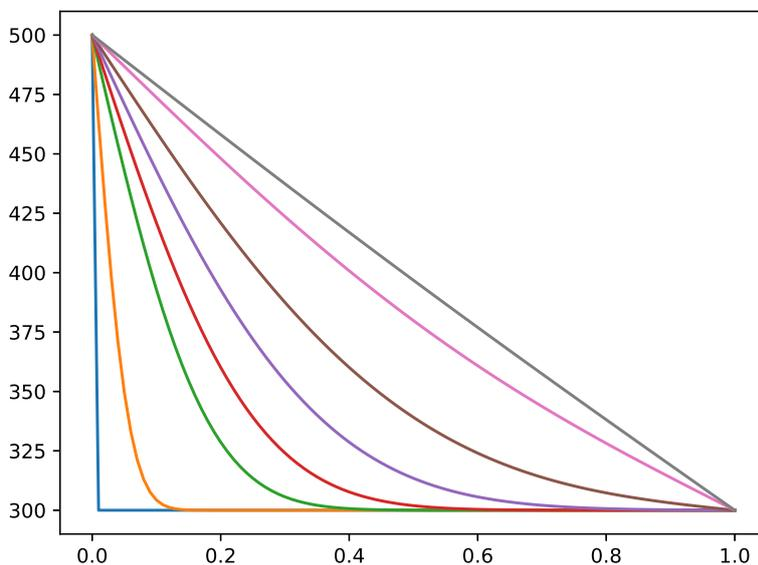
FIGURE 1 – Profils de température lors de la mise au contact avec un thermostat en  $x = 0$
