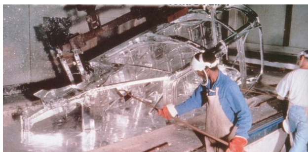
FIGURE 25 – Galvanisation d'une carrosserie
