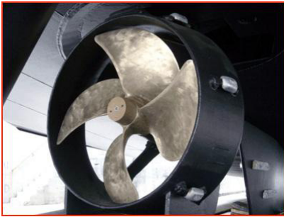
FIGURE 26 – Pains de zinc sur la carène et près de l'hélice d'un bateau
