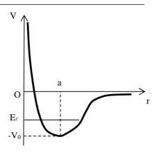
a-Commenter physiquement la forme de ce potentiel et proposer, en se plaçant à une dimension radiale r, une modélisation simplifiée utilisant un potentiel constant par morceaux dans trois régions distinctes que l'on précisera.
