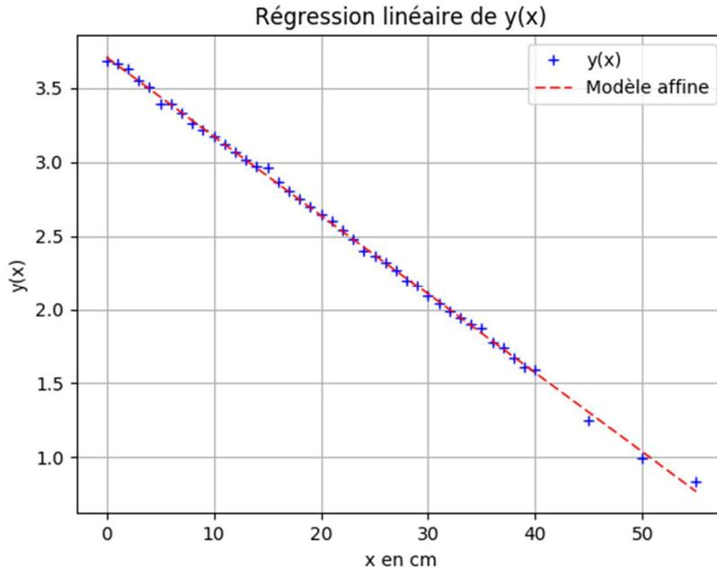
Pente négative  $\alpha = -0,05343 \text{ m}^{-1} \Rightarrow$  distance caractéristique de décroissance  $\delta = -\frac{1}{\alpha} \approx \underline{19 \text{ cm}}$
