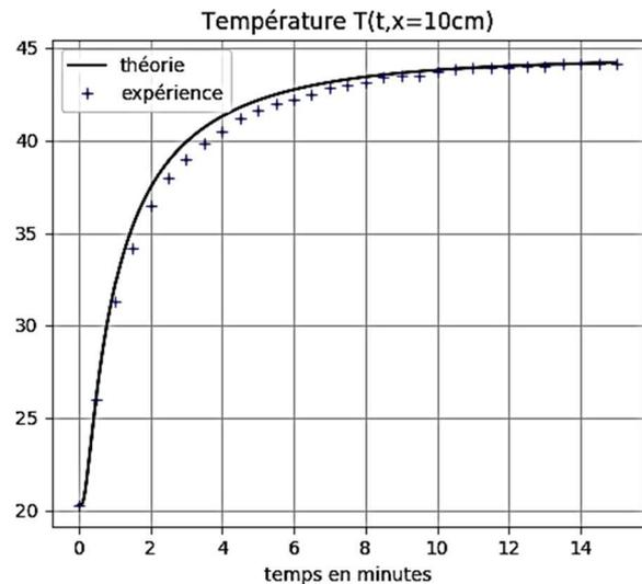
Ajustement obtenu pour :  $h = 15 \text{ W.m}^{-2}.\text{K}^{-1}$  et  $\lambda = 200 \text{ W.m}^{-1}.\text{K}^{-1}$
