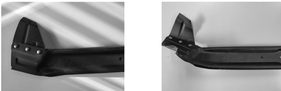
Figure 1- Lame avant et après impact
