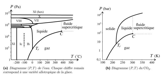
Figure 4 – Diagrammes(P,T) de corps purs.
