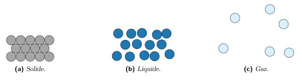
Figure 3 – Différents états de la matière d'un point de vue microscopique.
