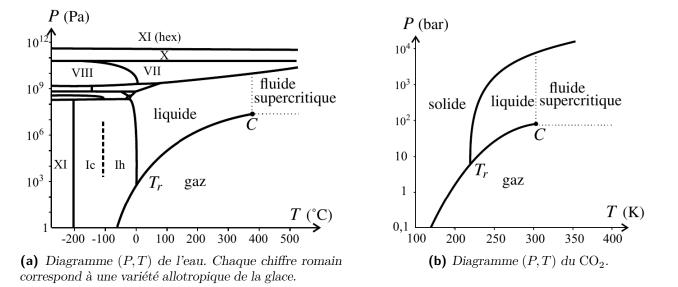
**Figure 4** – Diagrammes (P,T) de corps purs.
