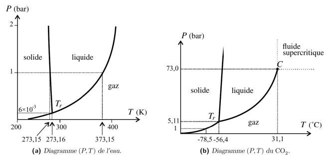
**Figure 5** – Diagrammes (P,T) de corps purs (agrandissements de la figure 4).
