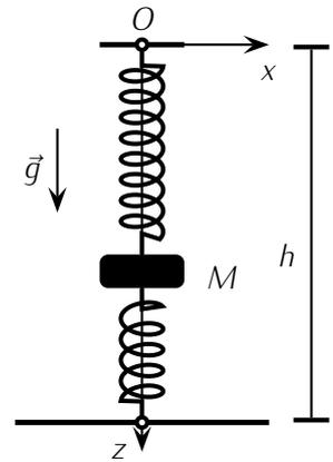
On se propose d'utiliser le système masse-ressort pour effectuer des mesures de masses en apesanteur. On se place dans le cas de deux ressorts identiques (de raideur  $k$  et de longueur à vide  $l_0$ ) écartés d'une distance  $h$  supérieure à la somme des longueurs à vide ( $h > 2l_0$ ). On écarte la masse d'une distance  $a$  par rapport à sa position d'équilibre et on note  $X$  l'écart à la position d'équilibre. L'équation du mouvement est :
