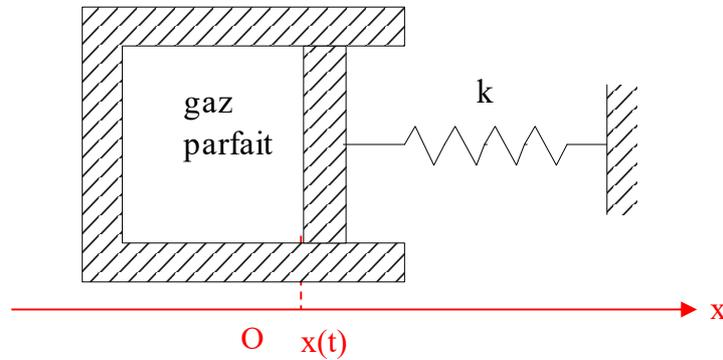
On choisit l'origine  $O$  de l'axe  $Ox$  au niveau de la position d'équilibre du piston (ressort non tendu)
