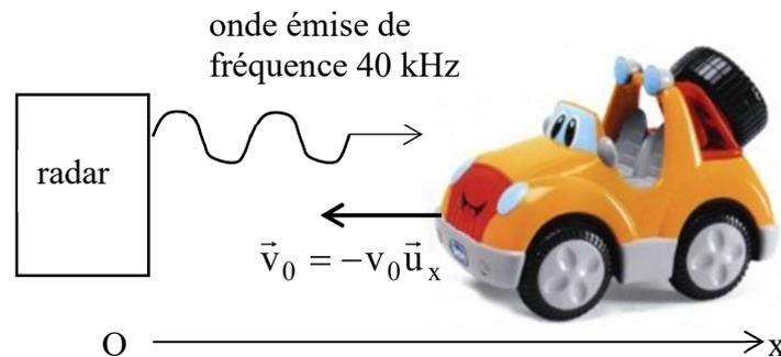
Signal émis :  $s_e(x,t) = s_{0i} \cos[\omega(t-x/c) - \varphi_i]$       Signal réfléchi :  $s_r(x,t) = s_{0r} \cos[\omega'(t+x/c) - \varphi_r]$
