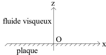
1-Le champ des vitesses dans le fluide s'écrit :  $\vec{v}(M, t) = v(x, y, z, t) \vec{u}_x$ .
