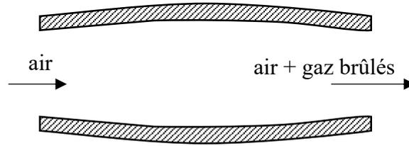
a-En supposant que la pression extérieure sur ( $S_1$ ) et ( $S_2$ ) est égale à la pression atmosphérique  $P_0$ , déterminer la force de propulsion que le réacteur communique à l'avion
