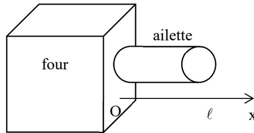
a-A l'aide d'un bilan d'énergie, montrer que :  $\frac{\partial \theta}{\partial t} - a \frac{\partial^2 \theta}{\partial x^2} + b\theta = 0$ .
