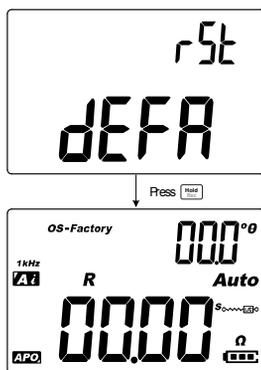
Figure 3-16 Réinitialisation des éléments de configuration
