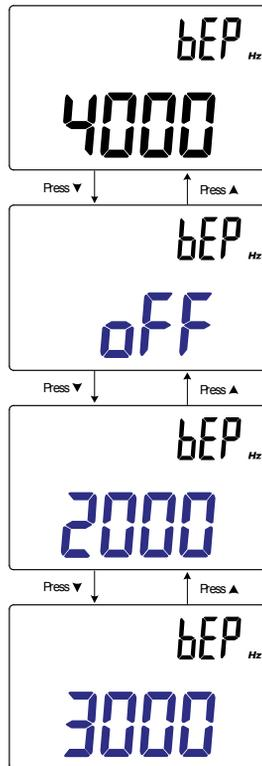
**Figure 3-13** Modification de la fréquence du signal sonore
