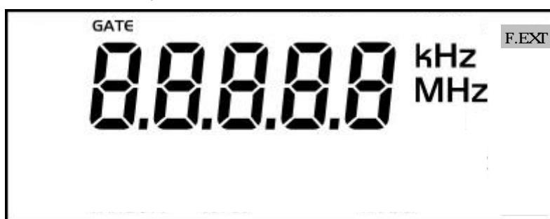
Dans ce mode, le symbole spécifique (en grisé sur la vue du LCD) est utilisé en plus de « **8.8.8.8** », « GATE », « kHz », « MHz » décrits aux paragraphes précédents.
