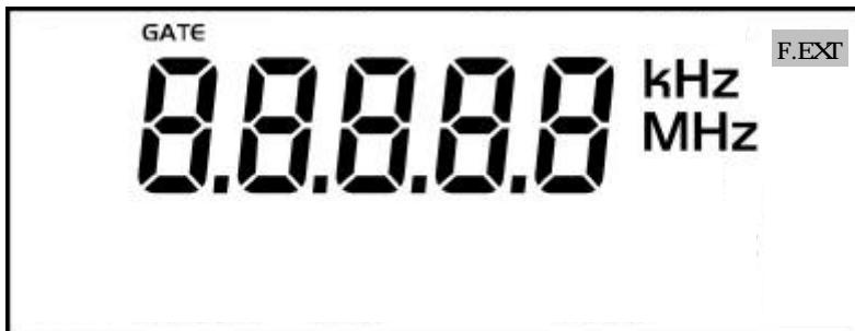
Bei dieser Betriebsart wird das spezielle Symbol (in der Ansicht des LCD-Displays grau unterlegt) zusätzlich zu den in den vorangegangenen Paragraphen beschriebenen Symbolen "8.8.8.8", "GATE", "kHz", "MHz" verwendet.
