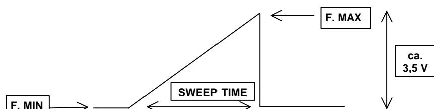
**Hinweis 1:** In der Betriebsart SWEEP intern werden auf der Anzeige abwechselnd die untere Frequenz "F. MIN" und die obere Frequenz "F. MAX" angezeigt.
