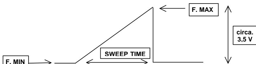
*Nota 1 : In modo SWEEP interno, il display indica alternativamente la frequenza bassa « F. MIN » e la frequenza alta « F. MAX ».*
