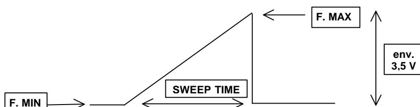
*Note 1 : En mode SWEEP interne, l'afficheur indique alternativement la fréquence basse « F. MIN » et la fréquence haute « F. MAX ».*
