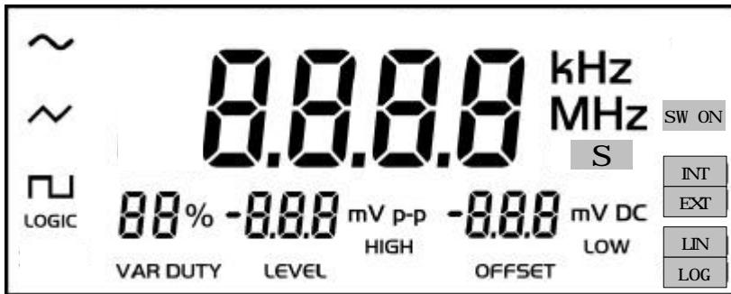
In dieser Betriebsart werden zusätzlich zu den Symbolen des Funktionsgenerators spezielle Symbole verwendet (oben in der Ansicht des LCD-Displays grau unterlegt):
