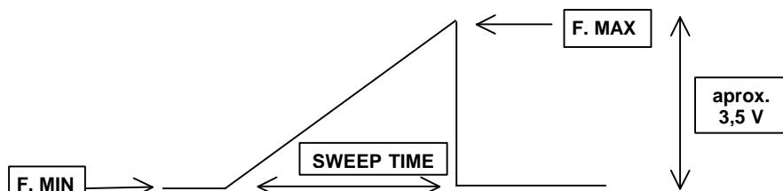
**Nota 1:** En modo SWEEP interno, el display indica alternativamente la frecuencia baja «F. MIN» y la frecuencia alta «F. MAX».
