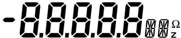
Mit den beiden Anzeigen mit insgesamt 14 Segmenten kann eine ganze Reihe von Einheiten für elektrische oder physikalische Messgrößen angezeigt werden.
