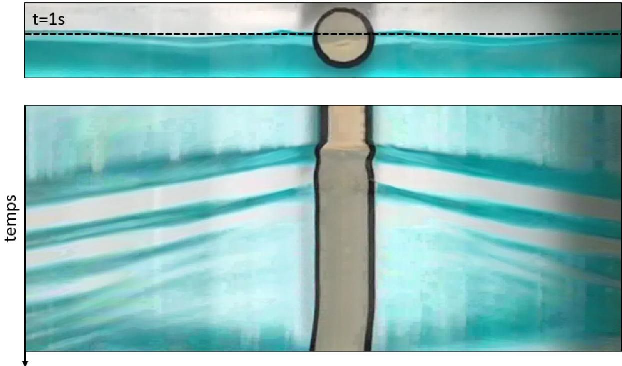
FIGURE 3 – Chronophotographie illustrant l'évolution de l'interface eau/air (cadence de 250 images par seconde sur une durée de 3 s). La ligne horizontale en trait pointillé tracée sur la photographie du haut représente la ligne des pixels suivis temporellement et qui est reportée chronologiquement, de haut en bas, pour former l'image du bas.
