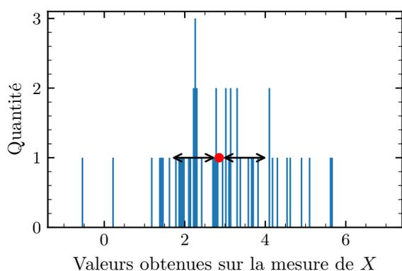
(a) Dispersion des mesures d'une grandeur  $X$  de moyenne  $\bar{X} = 2,85$  (point rouge) et d'écart-type  $\sigma_s = 1,27$  (largeur d'une double flèche).
