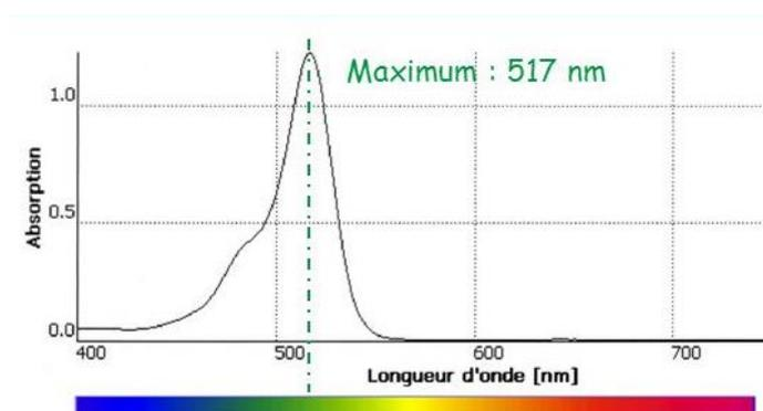
La solution mère d'éosine est obtenue en mélangeant 0,5 ml d'éosine du commerce en solution aqueuse à 2% (massique) avec de l'eau pour compléter à 500 ml.
