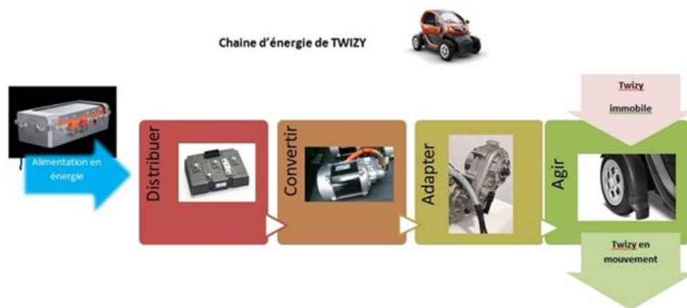
Figure 2 : Chaîne de puissance de la Renault Twizy
