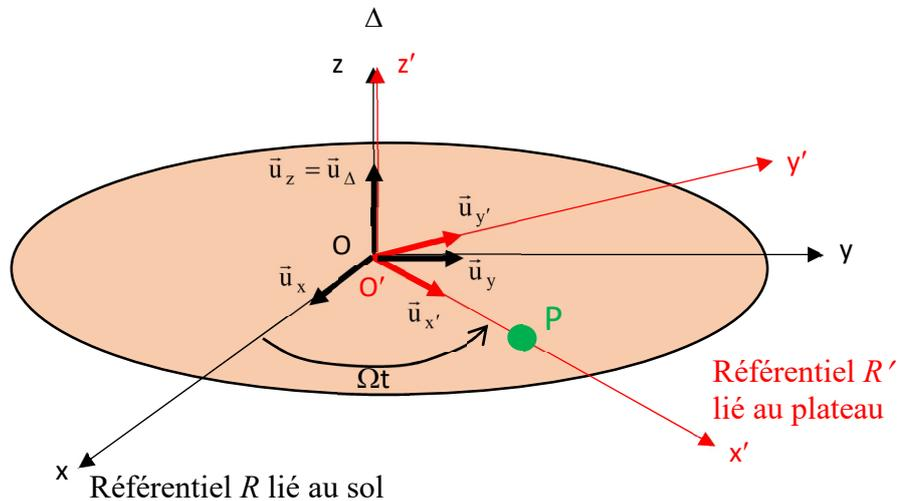
On suppose que la rainure qui guide le point P est selon l'axe  $Ox'$ .
