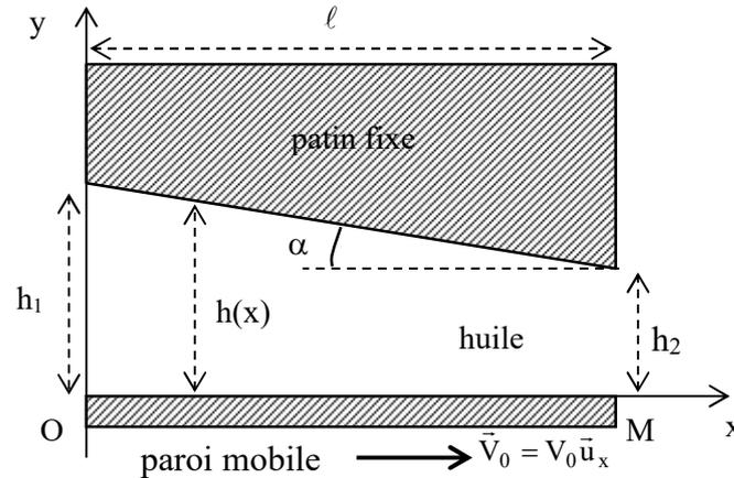
1-Ecrire la condition d'incompressibilité de l'écoulement.
