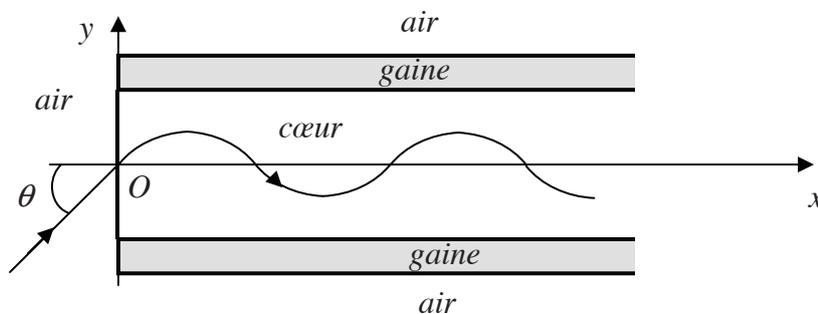
**Figure 7** – Fibre à gradient d'indice
