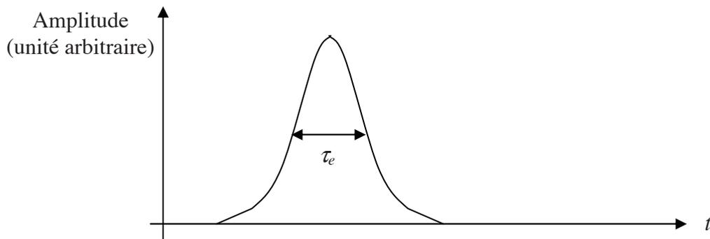
**Figure 6** – Impulsion lumineuse en entrée de fibre optique
