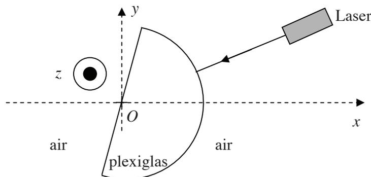
**Figure 4** – Expérience avec un demi-cylindre en plexiglas
