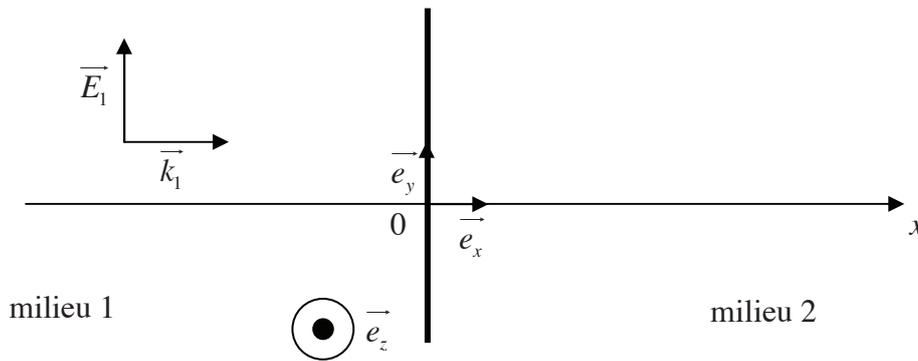
**Figure 13** – Coefficient de transmission
