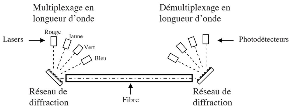
**Figure 9** – Multiplexage / démultiplexage par réseau de diffraction
