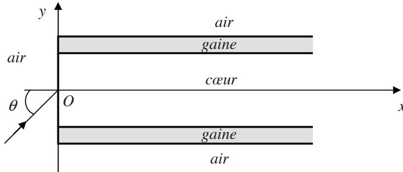
**Figure 5** – Fibre optique à saut d'indice
