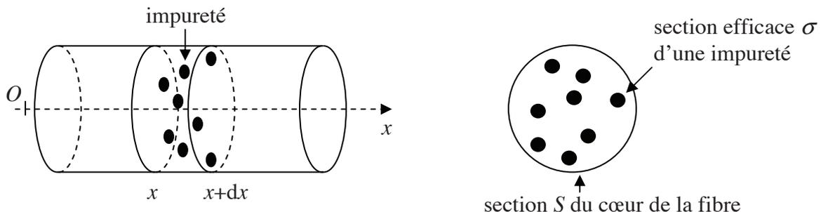
**Figure 10** – Impuretés dans une fibre
