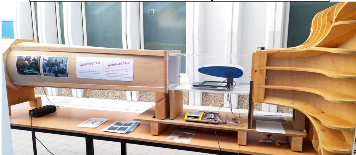
Le but de ce TP est d'étudier le comportement d'un tronçon d'aile d'avion en fonction de l'angle d'incidence, puis d'estimer sommairement les coefficients de portance  $C_z$  et de trainée  $C_x$  de ce tronçon d'aile, pour différentes incidences.
