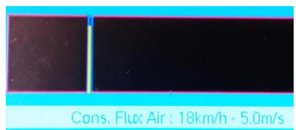
La mesure de la vitesse du flux d'air se fait au moyen d'une sonde à fil chaud. Son principe est de faire passer un courant dans un fil, qui se trouve à la fois échauffé par ce courant, et refroidi par l'écoulement de fluide (ici l'air). Sa température est directement liée à la vitesse de l'écoulement.
