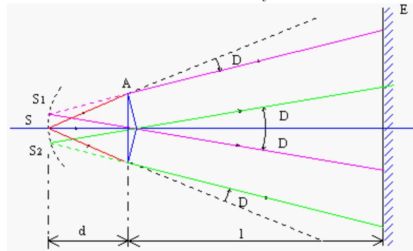
FIGURE 4 – Biprisme de Fresnel (source à distance finie)
