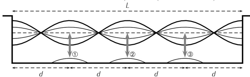
Il faudrait **3 injecteurs** placés à  $d = \frac{\lambda}{4}$  les uns des autres avec  $L = 2\lambda$  soit  $d = \frac{L}{4} = 3,0 \text{ m}$ . La fréquence des jets devrait être  $f$  telle que  $\lambda = \frac{c}{f} = \frac{L}{2} \Rightarrow f = \frac{2c}{L} = 0,67 \text{ Hz}$  et enfin, les injecteurs ① et ③ devraient être en phase, l'injecteur ② quant à lui devrait être en opposition de phase.
