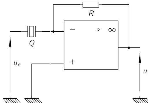
Où  $u_e = E \cos(\omega t)$ . Ce circuit est appelé « convertisseur courant-tension », la tension  $u_s$  est proportionnelle à l'intensité du courant circulant à travers le quartz.
