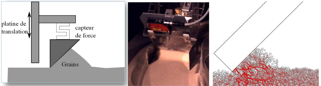
En régime permanent cette force est sinusoïdale et s'exprime sous la forme  $f(t) = F \cos(\omega t + \psi)$ . On représente ci-dessous l'allure de  $H = \frac{F}{y_0}$  et de  $\psi$  en fonction de la pulsation  $\omega$  (pour les expériences et les simulations).
