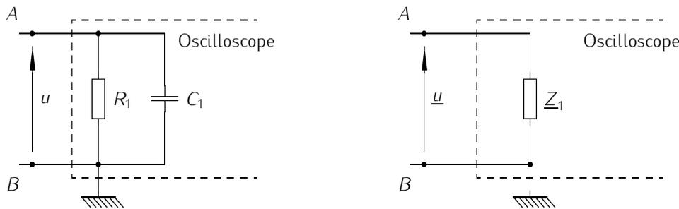
FIGURE 1 – Entrée de l'oscilloscope
