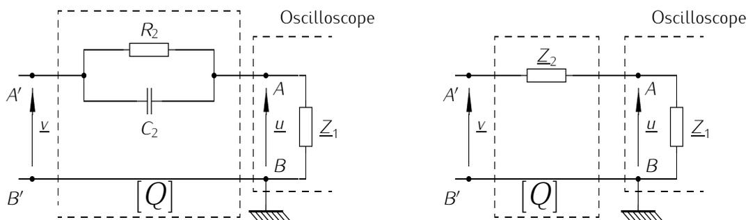
FIGURE 2 – Entrée de l'oscilloscope équipé d'une sonde
