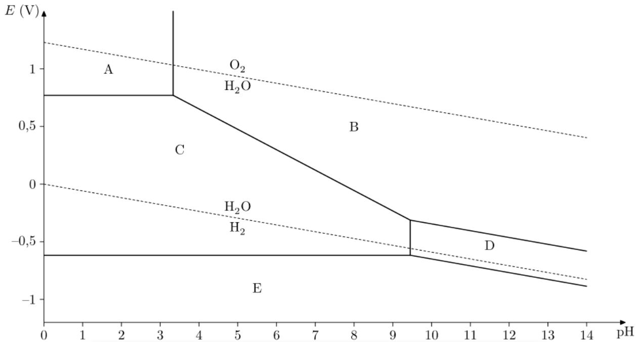
Figure 4 Diagramme potentiel-pH de l'élément fer
