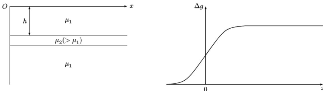
Figure 10 Anomalie gravimétrique pour une plaque horizontale semi-infinie
