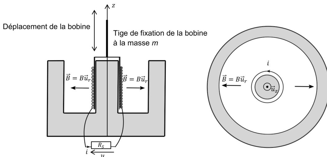
**Figure 4** - Schématisation du capteur de déplacement
