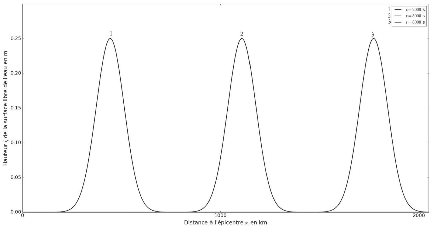
**Figure 14** - Propagation "simulée" d'une perturbation "Gaussienne" à la surface de l'eau à partir de l'épicentre, la profondeur est représentée (**figure 13**). Les différentes courbes représentent la surface de l'eau à différents instants
