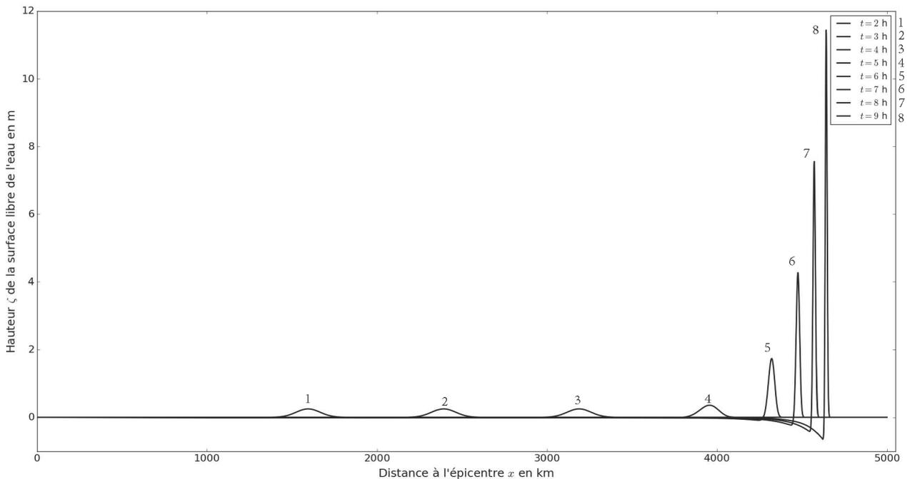
**Figure 12** - Propagation "simulée" d'une perturbation "Gaussienne" à la surface de l'eau à partir de l'épicentre, la profondeur est représentée (**figure 13**). Les différentes courbes représentent la surface de l'eau à différents instants
