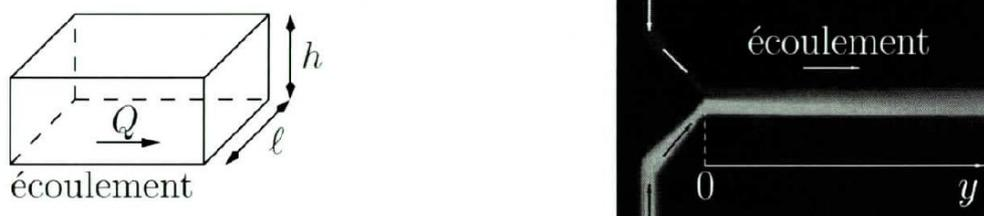
**Figure 10** – À gauche : schéma d'un canal de section rectangulaire. À droite : diffusion de la fluorescéine au confluent de deux canaux microfluidiques
