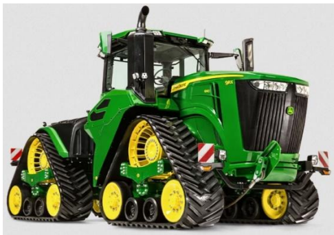
Figure 1 : Transmission à 4 chenilles indépendantes
