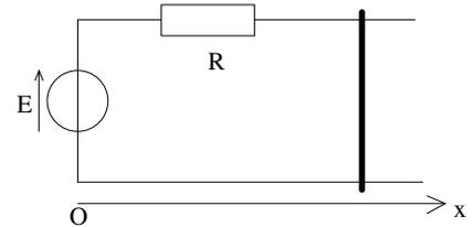
a-Lorsqu'un courant électrique parcourt le circuit, le barreau se met en mouvement. Expliquer pourquoi.
