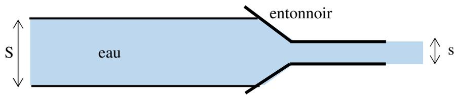
Un opérateur applique un entonnoir à l'extrémité d'un tube de section  $S$  dans lequel s'écoule un courant d'eau (vitesse  $V_1$ , pression  $P$ , masse volumique  $\mu$ ). La pression ambiante est  $P_0$ .
