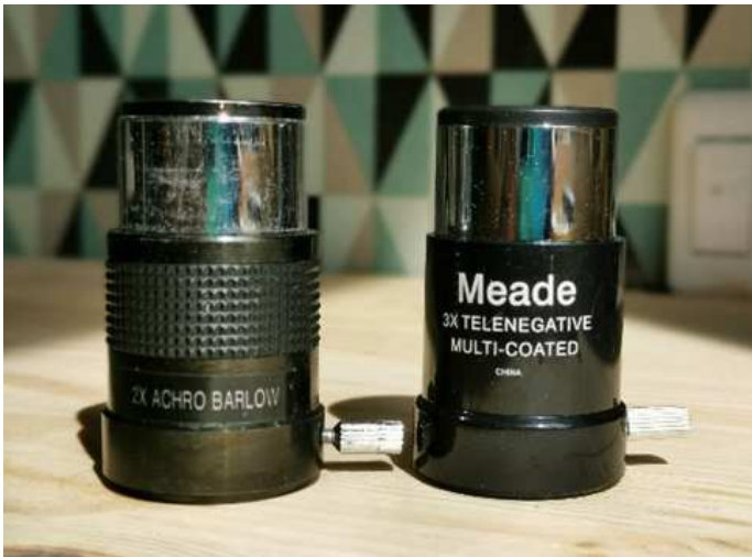
FIGURE 2 – : deux lentilles de Barlow. Celle de gauche augmente le grossissement d’un facteur 2, celle de droite d’un facteur 3.
