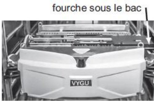
Figure 5 - Prise d'un bac (fourche sous le bac dans un rack)
