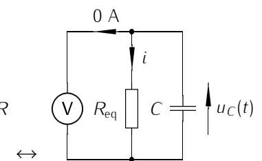
2. L'énergie  $E_C(t)$  contenue dans un condensateur aux bornes duquel la tension est  $u_C(t)$  s'exprime sous la forme  $E_C(t) = \frac{1}{2} C u_C(t)^2$ .
