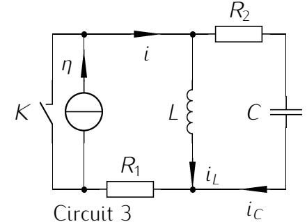
Pour déterminer les conditions initiales, on représente chaque circuit à  $t = 0^-$  puis à  $t = 0^+$  en tenant compte de la continuité de la tension aux bornes des condensateurs et de l'intensité du courant dans les bobines.
