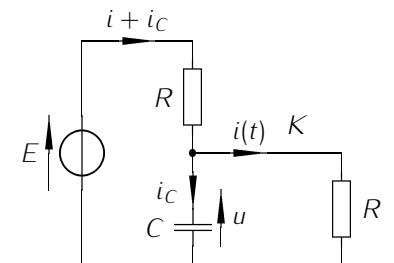
Pour déterminer  $i(0^+)$ , on doit utiliser une grandeur qui ne peut pas subir de discontinuité : la tension  $u$  aux bornes du condensateur.
