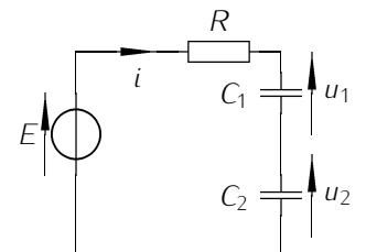
(a) Les deux condensateurs étant en convention récepteur (circuit ci-dessus à gauche), on peut écrire  $i_1 = \frac{dq_1}{dt}$  et  $i_2 = \frac{dq_2}{dt}$ . Comme ils sont également montés en série, on a aussi  $i_1 = i_2$  à tout instant d'où par intégration,  $q_1(t) = q_2(t) + Cte$ .
