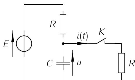
Soit le montage représenté ci-contre. Pour  $t < 0$ , le circuit est en régime permanent, c'est à dire que le générateur de tension est allumé depuis longtemps et  $K$  ouvert depuis longtemps.
