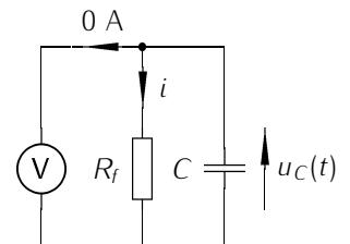
Si on bascule l'interrupteur en position 2 après avoir rechargé le condensateur, on se ramène au circuit représenté ci-contre.
