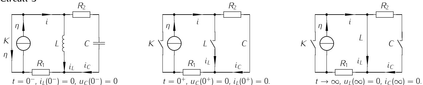
Pour  $t < 0^-$ ,  $K$  est fermé et la partie située à droite du générateur de courant est court circuitée : tout le courant passe par  $K$  fermé et toutes les intensités et tensions sont nulles à droite du générateur.
